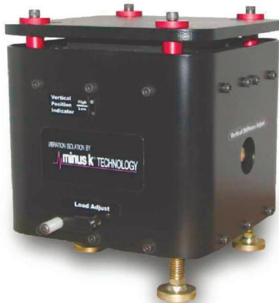
Низкочастотный виброизолятор для нагрузок весом от 50 до 800 фунтов с собственной частотой до 1/2 Гц в вертикальном и горизонтальном направлениях.
