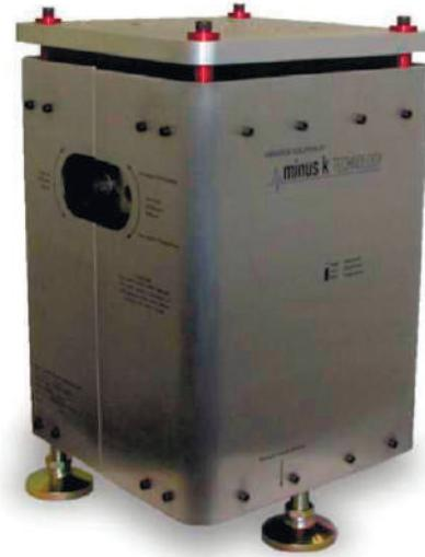
**Низкочастотный виброизолятор для нагрузок весом от 500 до 4200 фунтов с частотой собственных колебаний до 1/2 Гц в вертикальном и горизонтальном направлениях.**
