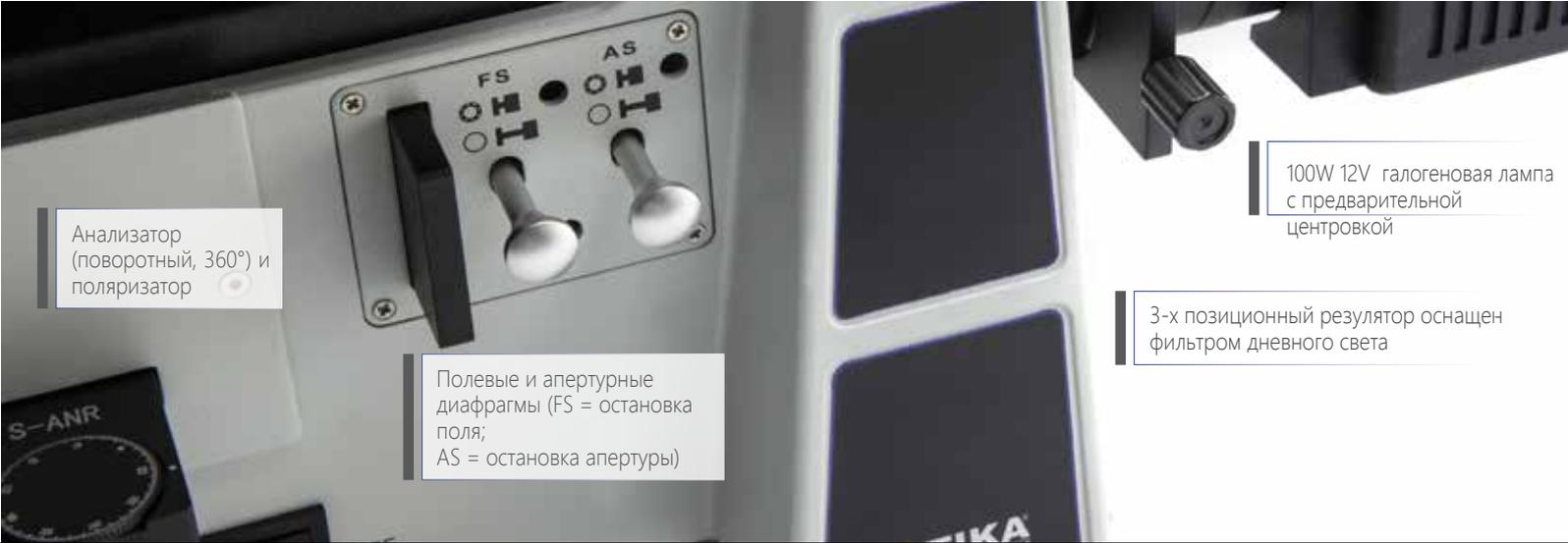
Анализатор (поворотный, 360°) и поляризатор
