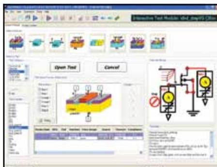
При необходимости быстро измерить параметры корпусного устройства удобный программный интерфейс с помощью мастеров настройки позволяет легко найти и выполнить желаемый тест, например показанное на рисунке стандартное измерение характеристик полевого транзистора
